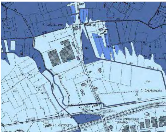
Area di Via del Castelluccio - PGRA, estratto. La nuova area in ampliamento rientra nella pericolosità P1 .Bassa
