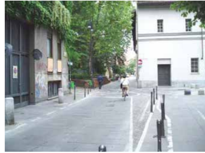
figura 2.16 La corsia ciclabile contromano non ha qui nessuna protezione ed è regolata dall'usuale segnale di divieto di accesso con pannello integrativo 'escluso biciclette'. [Milano - Foto Polinomia]
