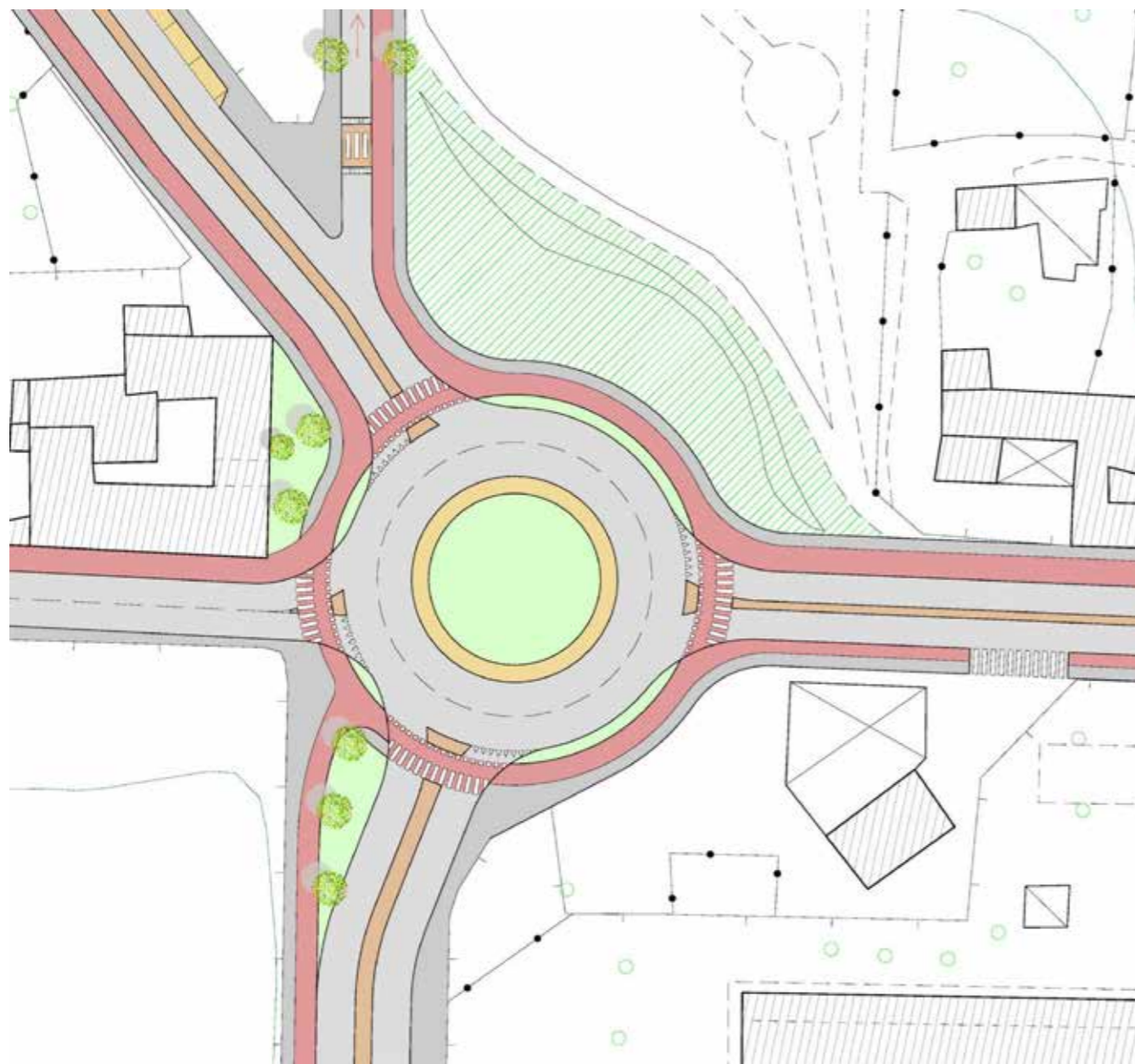
figura 2.14 Esempio di inserimento di una pista ciclabile bidirezionale in una rotatoria con diametro di 32 metri: la circolazione esterna è messa in sicurezza attraverso l'utilizzo di una separazione fisica (in questo caso un'aiuola) e la distanza dell'attraversamento ciclabile dalle linee di arresto è di 2 metri, per garantire un'adeguata riduzione del disturbo dell'attraversamento rispetto al funzionamento della rotatoria. [Progetto per Sesto Fiorentino (FI) - Disegno Polinomia]
