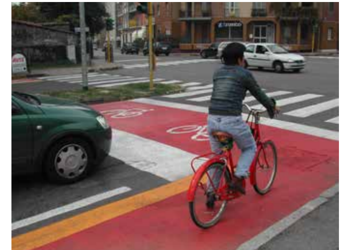
figura 2.22 Esempio di ‘casa avanzata’ di attestamento per le biciclette [San Donato Milanese – Foto Polinomia]
