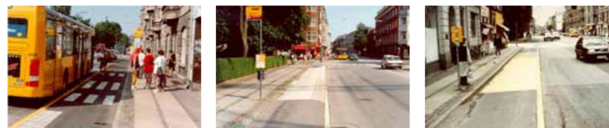
figura 2.33 Esempi danesi di risoluzione del conflitto tra pedoni e ciclisti alle fermate del trasporto pubblico (Adonis: "Best practice to promote cycling and walking" - 1998)
