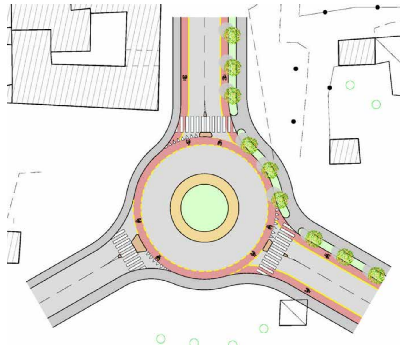
figura 2.12 Esempio di inserimento di una pista ciclabile monodirezionale in una rotatoria con diametro di 28 metri: la corsia ciclabile può essere riportata direttamente in corona, senza tuttavia allargare la sede carrabile; tale indicazione infatti riveste sostanzialmente il significato di sottolineatura della presenza ciclabile e di segno di continuità dei percorsi. [Progetto per Sesto Fiorentino (FI) - Disegno Polinomia]
