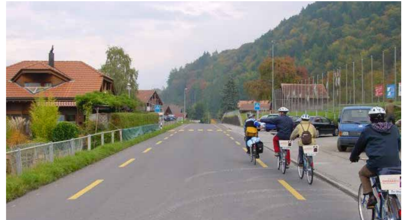
figura 2.3 Esempio di realizzazione di banchine laterali con semplice segnaletica e restringimento delle corsie autoveicolari [Berna – Foto Polinomia]
