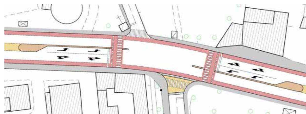
figura 2.25 Esempio di continuazione della pista attraverso l'intersezione, realizzata con una banda colorata [Progetto per Sesto Fiorentino – Polinomia]
