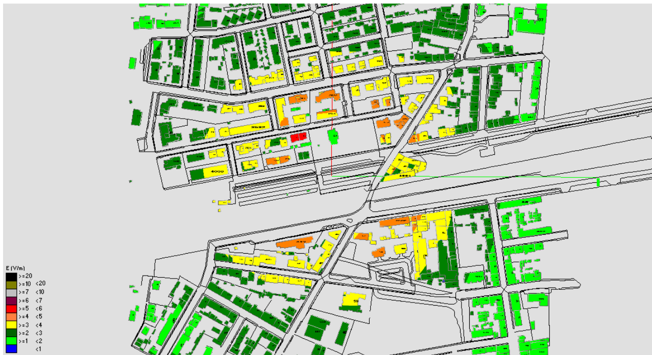
Fig. 36 Impatto elettromagnetico – Zona Via Buozzi – Vista dall'alto
