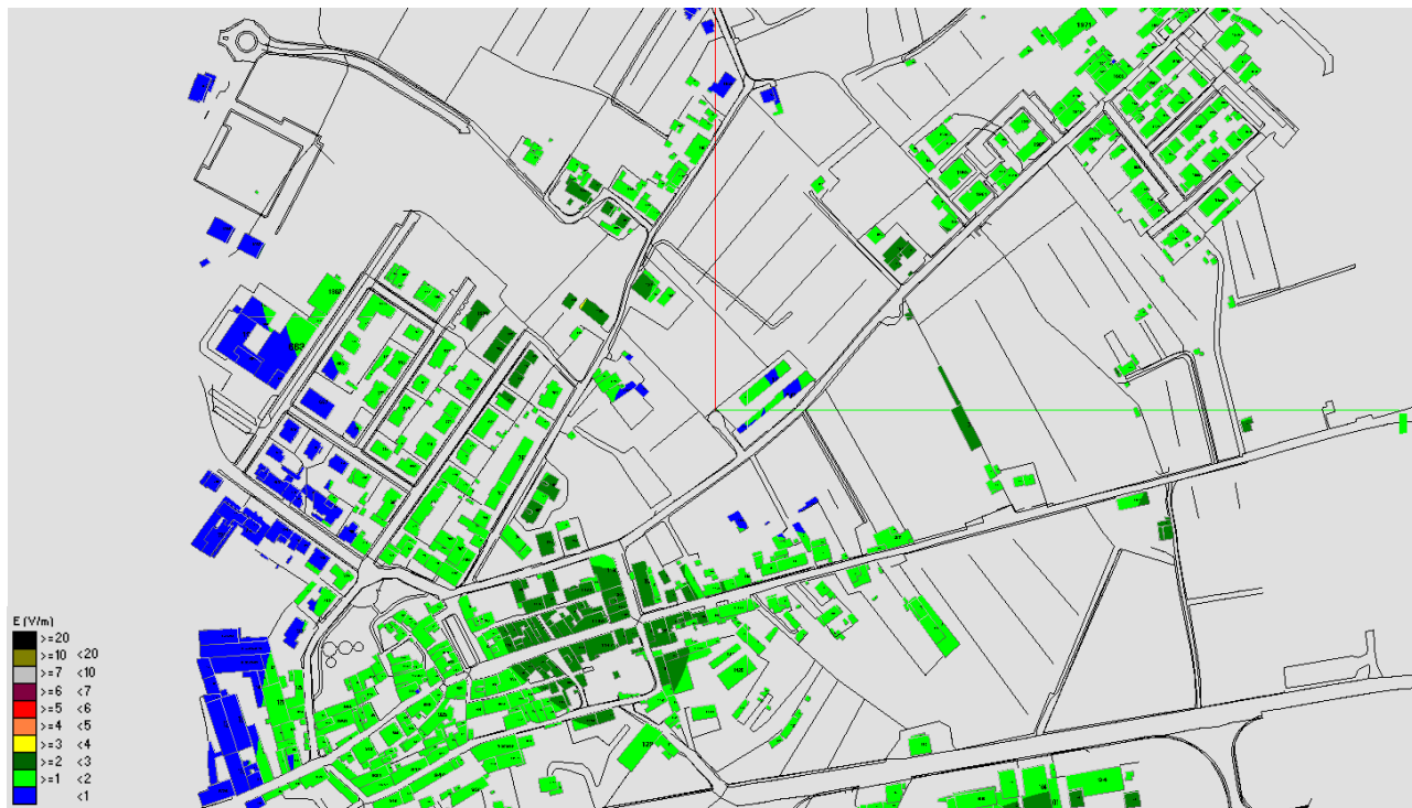
Fig. 24 Impatto elettromagnetico – Zona Parcheggio Cimitero Cortenuova – Vista dall'alto
