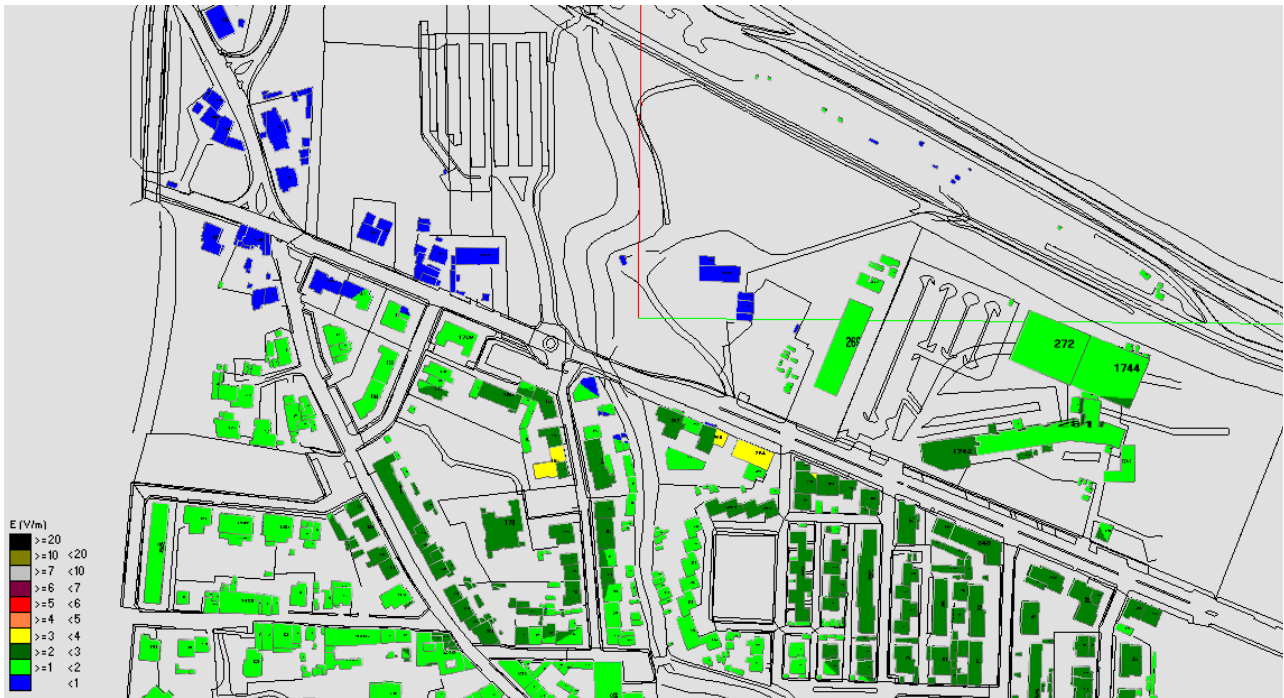
Fig. 21 Impatto elettromagnetico – Zona Area Verde Via Boccaccio – Vista dall'alto
