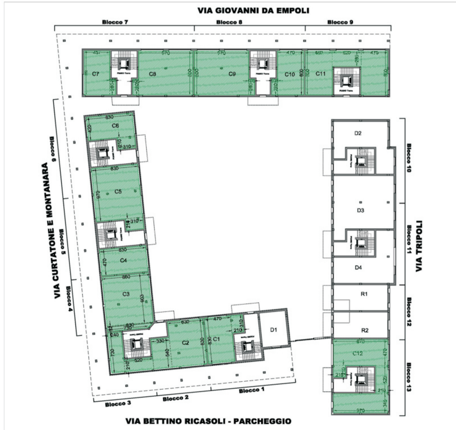
PIANO TERRA (primo piano fuori terra) con individuazione Superficie di vendita scala 1:200
