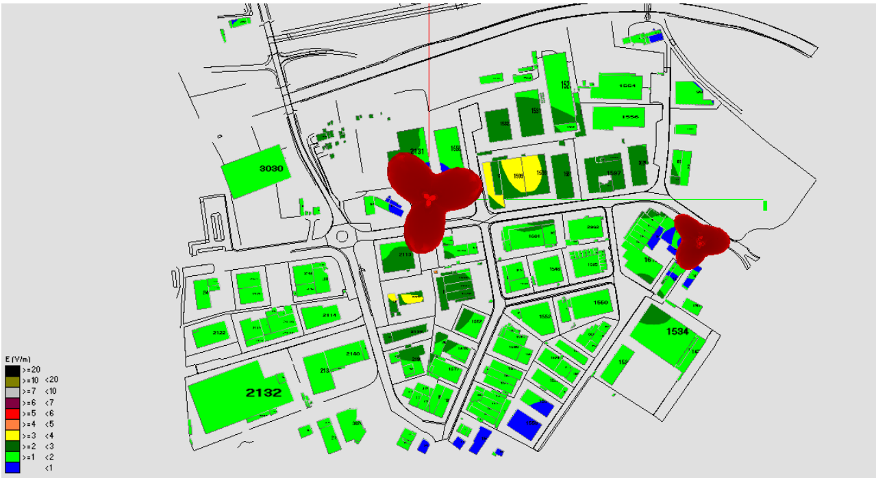
Fig. 48 Impatto elettromagnetico – Zona Parcheggio Via I Maggio – Vista dall'alto
