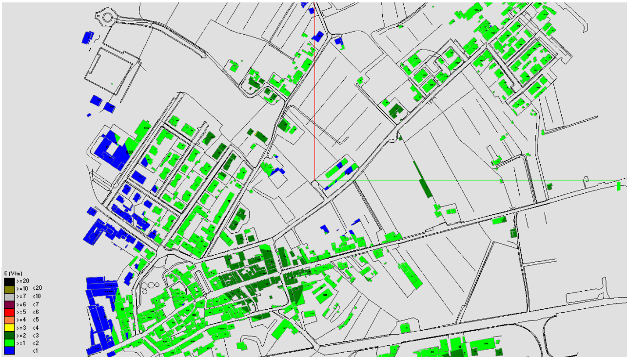
Fig. 27 Impatto elettromagnetico – Zona Parcheggio Cimitero Cortenuova – Vista dall'alto
