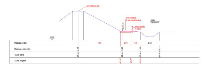
Una volta superata la SP N. 11 il percorso giunge in prossimità dell'immissione in Arno del fiume Elsa, pertanto per garantire la continuità del percorso ed il collegamento con il territorio del Comune di San Miniato, il progetto prevede di procedere lungo il piede arginale del fiume Elsa fino al ponte di confine con la provincia di Pisa.
