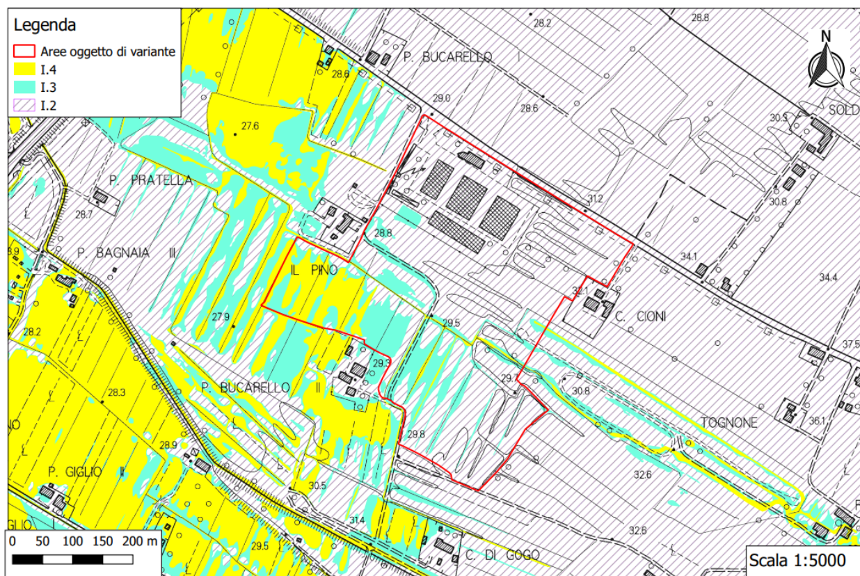
Figura 2: carta della pericolosità idraulica ai sensi del DPGR 53/R (Variante Aree Produttive)
