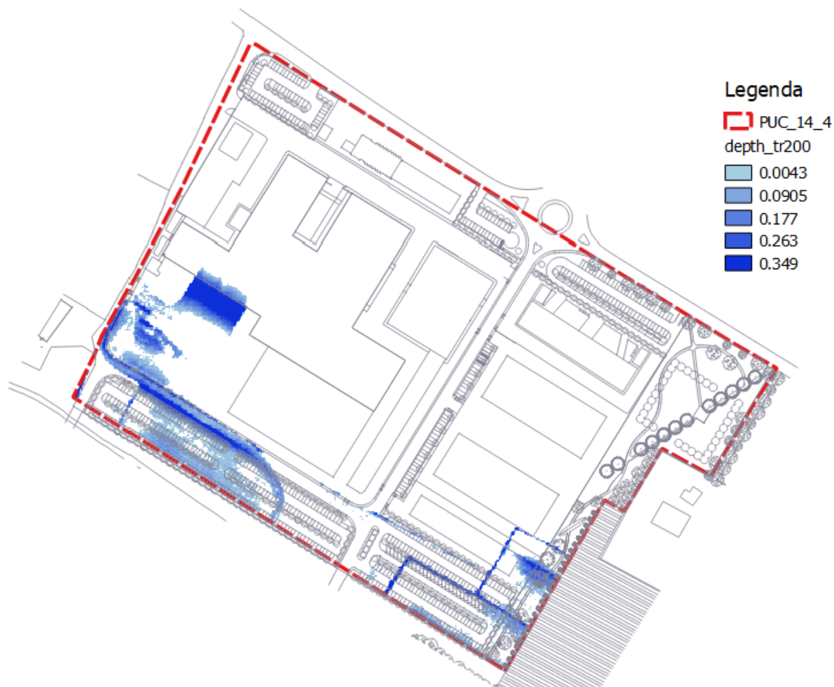
Figura 5: carta dei battenti TR200 anni da studio idraulico a supporto della Variante Aree Produttive
