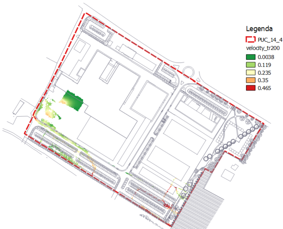
Figura 6: carta delle velocità TR200 anni da studio idraulico a supporto della Variante Aree Produttive
