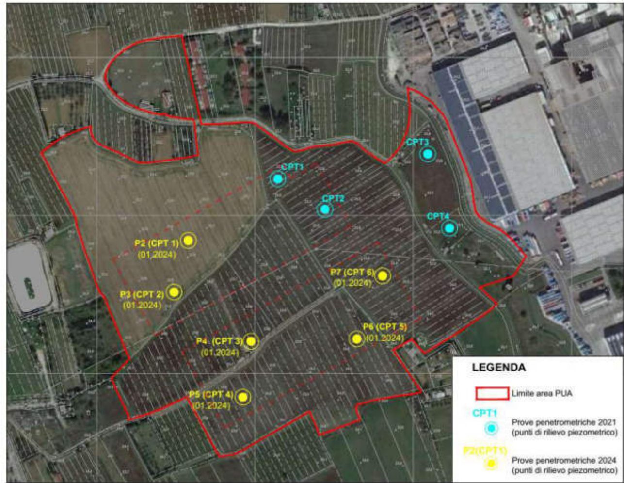
Fig. A: Ubicazione punti di misura piezometrica
